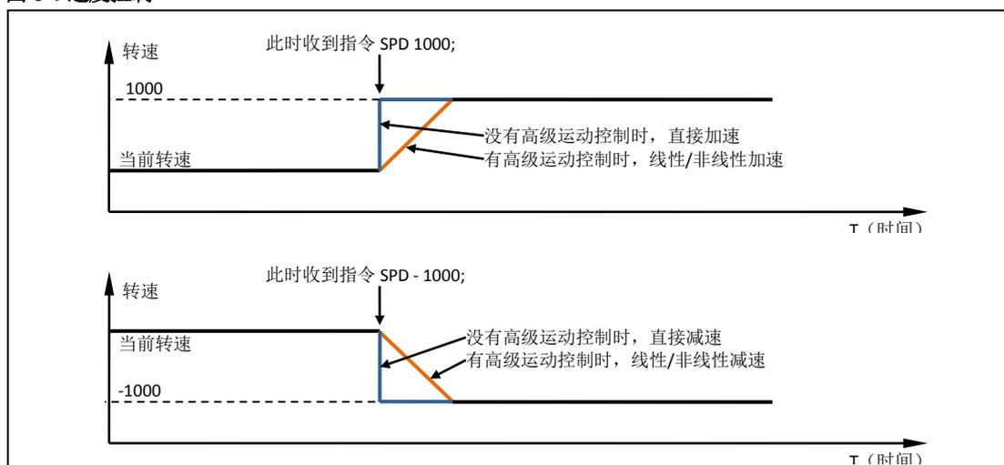
注意，速度值的正负决定了电机的转向。因此，如果使用指令 SPD 1000;或者 SPD +1000;都会让电机以正向 1000pps 的速度转动。同样的，如果使用指令 SPD -1000;（负 1000），则会让电机以反向 1000pps 的速度转动。
