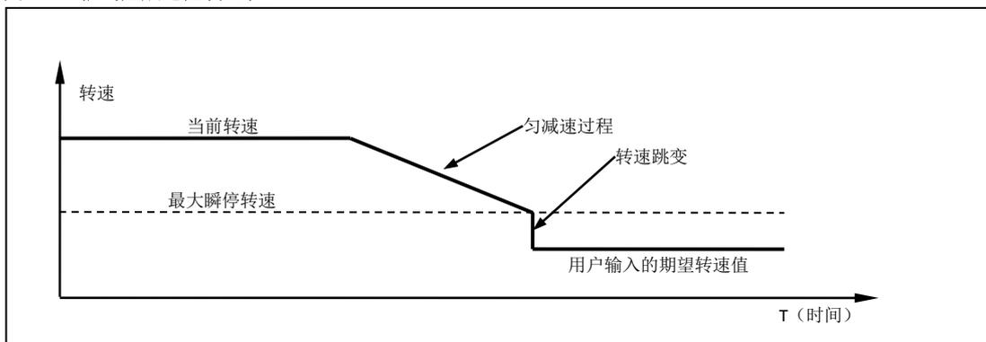
如果用户设定的期望转速低于最大瞬停转速，并且当前电机的实际转速低于最大瞬停转速，则转速跳变到用户设定值。
