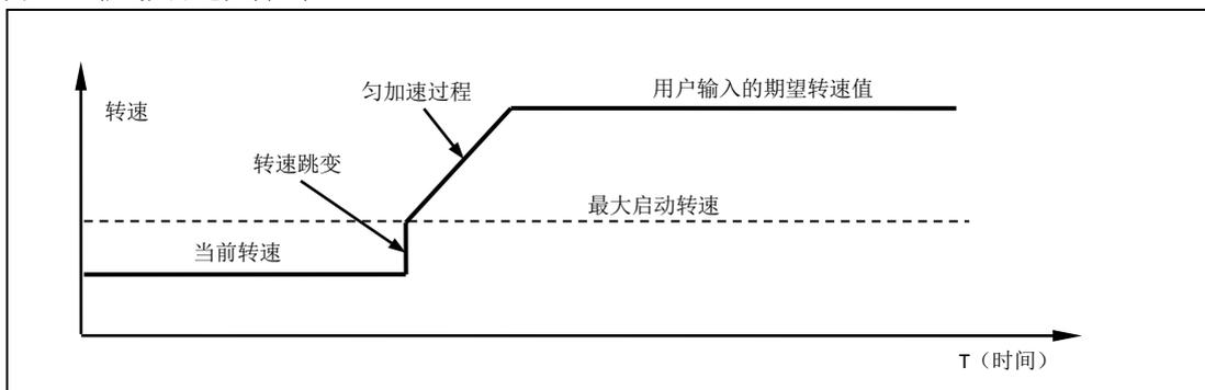
如果用户设定的期望转速小于最大启动转速，则转速直接跳跃到用户设定的期望值。
