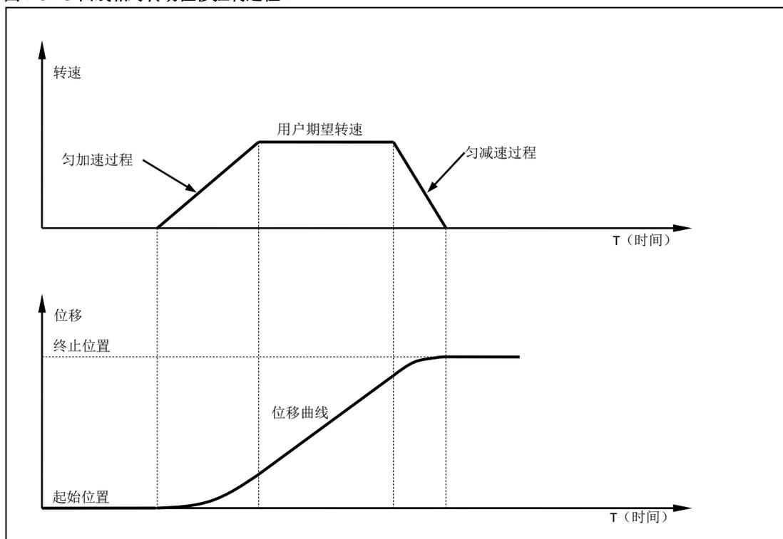
在控制过程中，控制系统将连续估算减速过程应发生的时刻，以保证在到达用户设定的终止位置时，速度正好为零。该估算过程用时在 20 微秒（5 万分之一秒）左右。精度为 64 位。在实际应用中，如果用户设定的相对位移过小而期望速度过大，则为了保证在达到用户设定的终止位置时速度为零，则控制系统在达到期望速度之前，就必须减速。如图 7-10 所示。
