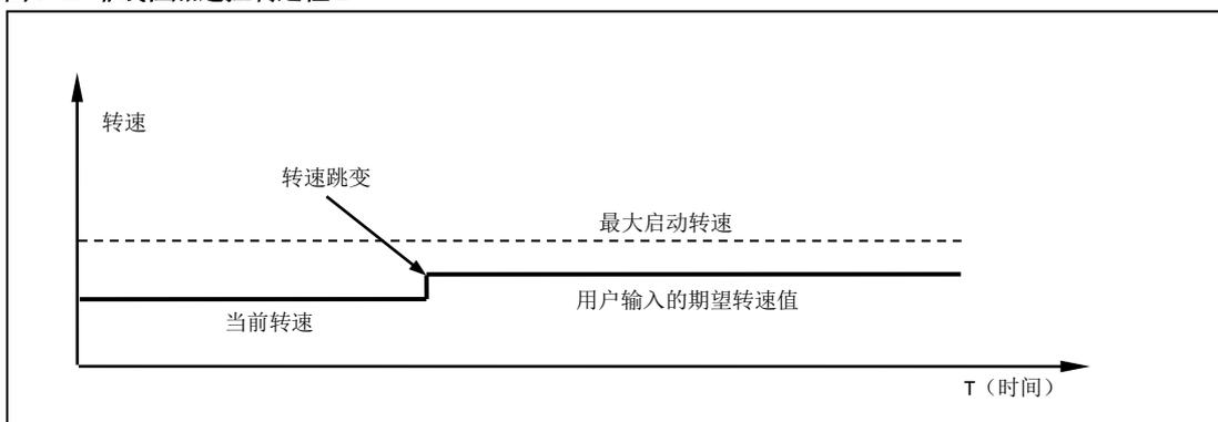
如果当前电机的实际转速高于该最大启动转速，则使用均匀加速控制，将转速加速到到用户设定的期望值。
