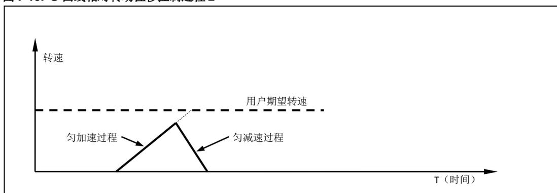
虽然以上列出的图例只展示了使用匀加减速实现 S-曲线位移控制原理。UIM2842 的运动控制系统实际应用了前面提到的所有加减速方式，包括匀加减速和折线加减速。值得注意的是，如果对运动的平滑性要求很高，折线加减速不是很适用，因为速度存在突变。要取消折线加减速，只需将最大启动速度和最大截停速度设置为零就可以了。下图列出了折线加减速在 S-曲线位移控制中的情况。
