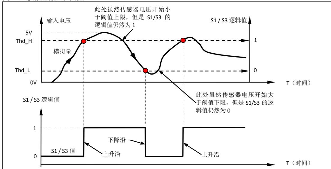
用户可以通过指令将 S1 或 S3 端口配置为模拟量输入。配置是通过将主配置寄存器 MCFG 中的 ANE 位置 1 (使能模拟量输入,  $MCFG<ANE> = 1$ ); 并配置 MCFG 的 CHS 位实现的。配置完成后，用户可以立刻用 SFB; 指令查询端口输入电位信息。
