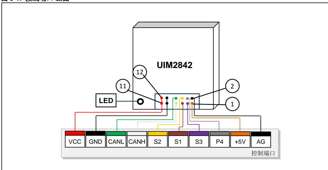
图 0-2: 接线端口-背面
