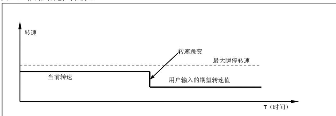
注意: 将最大启动速度和最大截停速度设置为零(0)，即可禁止系统使用非线性加速控制, 而只使用匀加速控制。
