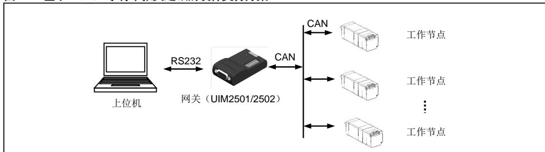
图 2-2: 基于 CAN 报文通讯的硬件支持方案
