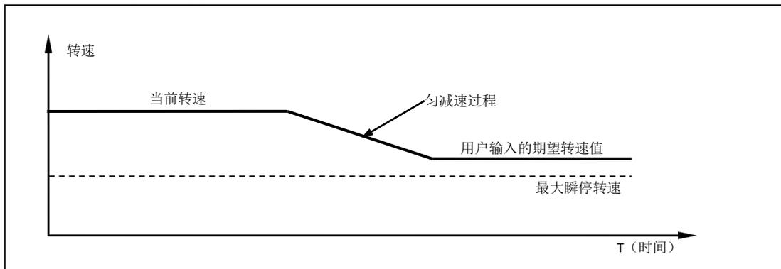
如果用户设定的期望转速低于最大瞬停转速，当前电机的实际转速高于最大瞬停转速，则转速先匀减速到最大瞬停转速，然后跳变到用户设定值。
